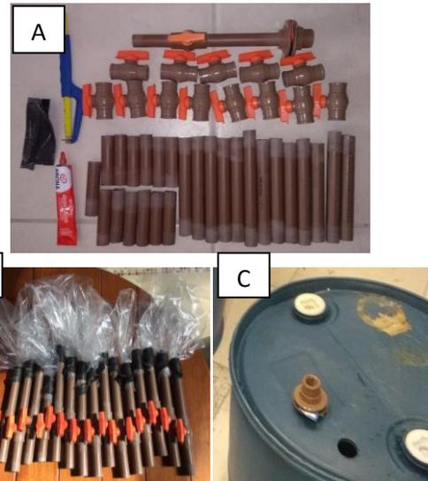
Figura 1: Materiais utilizados na confecção dos *seepage meter*.
