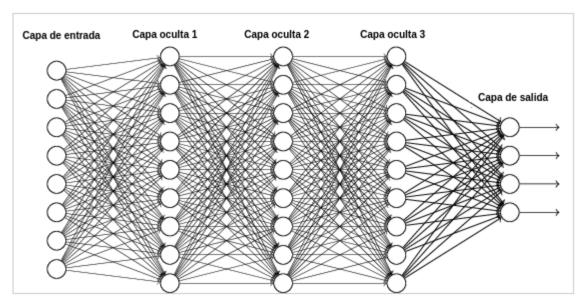
Figura 2.4. Estructura de una NN: las neuronas se organizan en capas.<sup>6</sup>
