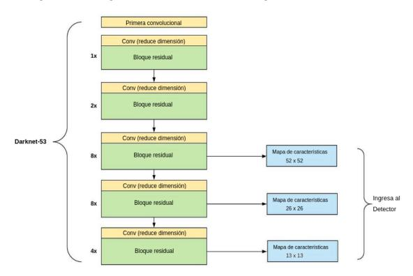
Figura 2.18. Estructura del extractor de características Darknet-53.<sup>24</sup>
