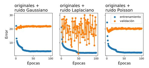
Figura 4.10. Errores de entrenamiento y validación de conjuntos que quintuplican bunch120 (ruidos), entrenando con batch\_size = 2 y  $LR = 1 \times 10^{-4}$ .
