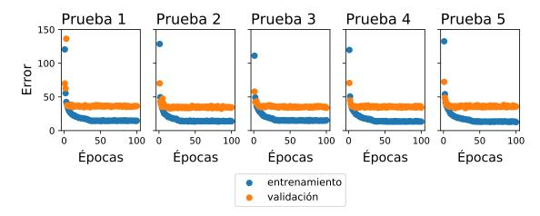
Figura 4.18. Errores de entrenamiento y validación, al tomar las imágenes de entrenamiento de bunch120 de forma aleatoria.
