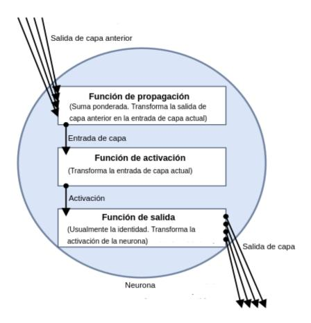
Figura 2.5. Estructura de una neurona.<sup>7</sup>
