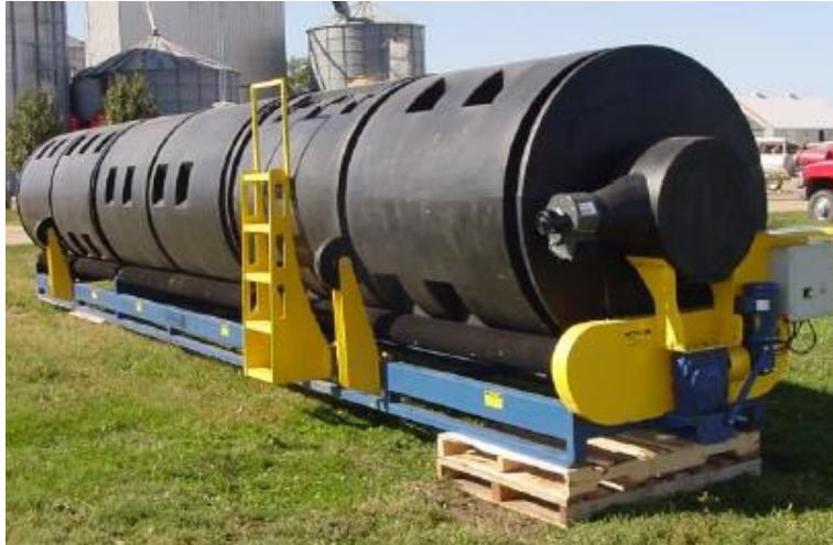
Figura 8: Sistema de compostaje en tambores.
