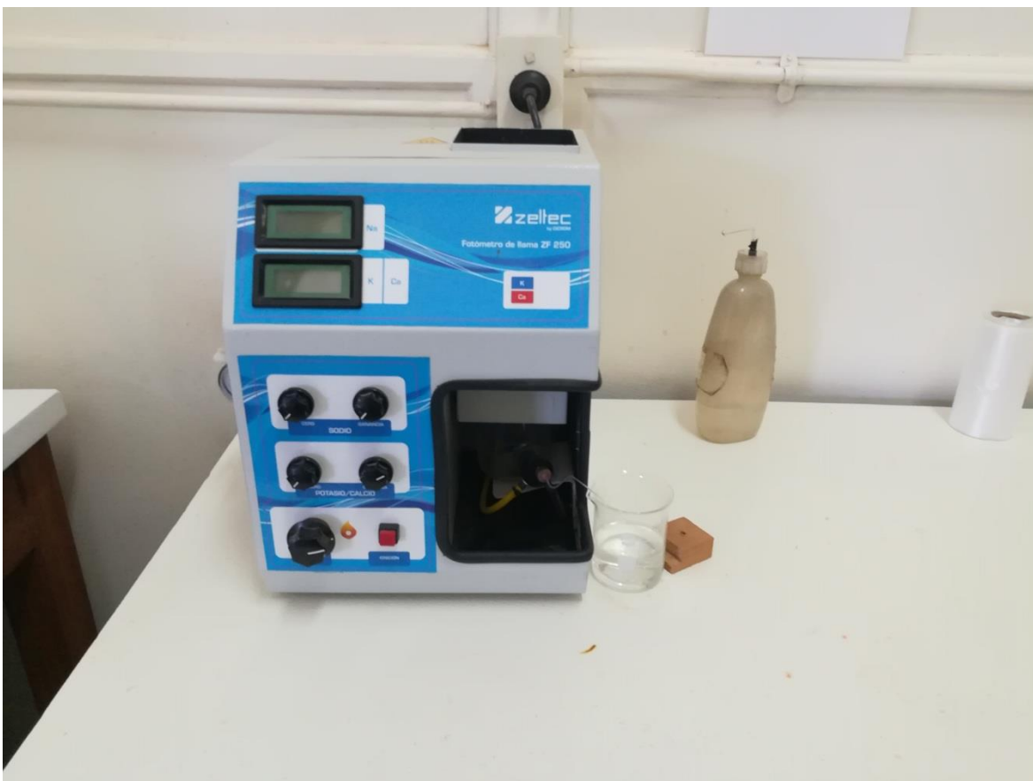
Figura 18: Fotómetro de llama utilizado para la medición de Potasio total. Cátedra de Química Agrícola de la Facultad de Ciencias Agrarias – UNCUYO, Octubre 2019.
