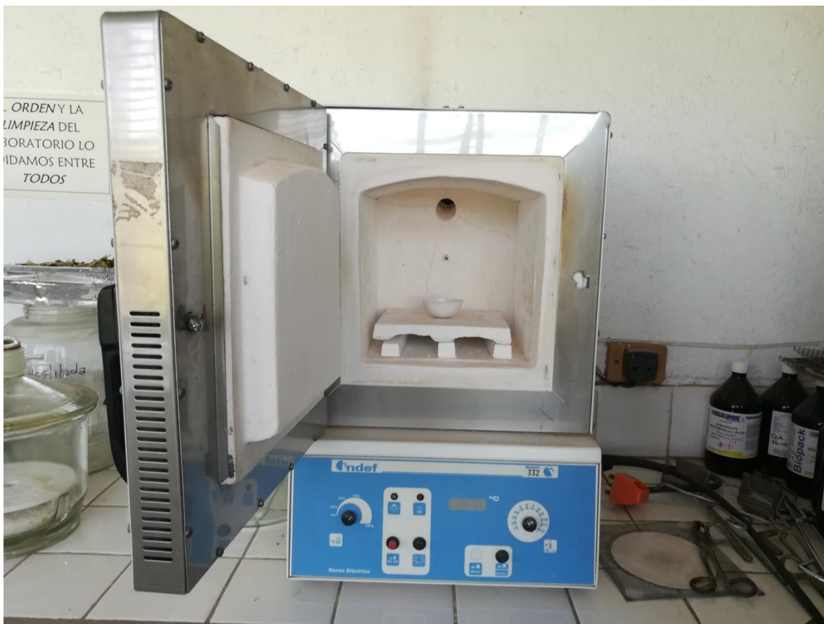
Figura 14: Cápsula de porcelana ubicada dentro de una mufla para realizar el análisis de cenizas. Cátedra de Química Agrícola de la Facultad de Ciencias Agrarias – UNCUYO, Octubre 2019.
