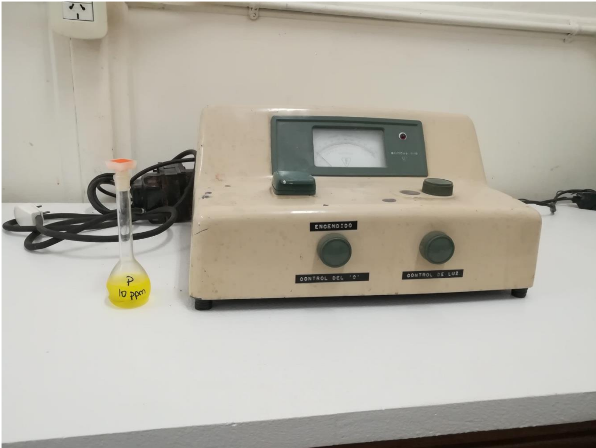
Figura 17: Fotocolorímetro utilizado para la determinación de Fósforo total, junto a un matraz con una dilución de la solución patrón utilizada para realizar la curva de calibración. Cátedra de Química Agrícola de la Facultad de Ciencias Agrarias – UNCUYO, Octubre 2019.
