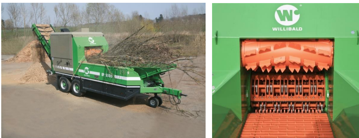
Figura 19: Fotografía de la trituradora Willibald Shark EP 5500 en funcionamiento [A] y detalle de la cinta y boca de alimentación con los respectivos martillos de trituración [B].
