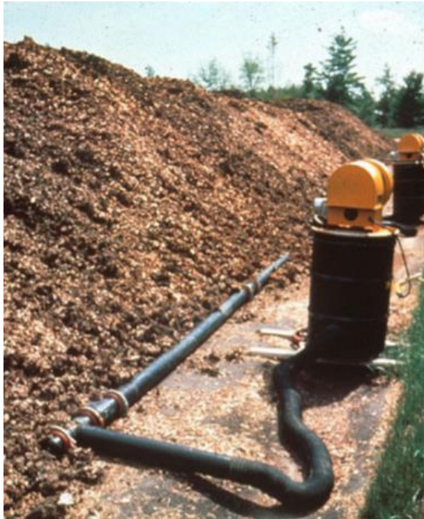
Figura 5: Pila de compostaje con ventilación forzada en un sistema abierto.
