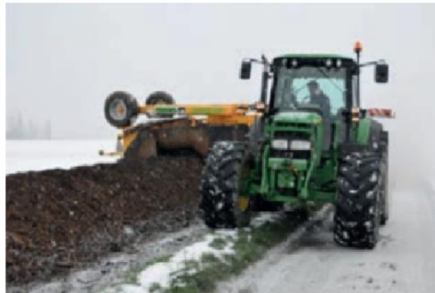
Figura 7: Sistema de compostaje en hilera agitada por máquina volteadora.
