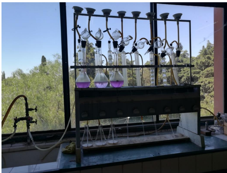
Figura 16: Balones conectados a equipo de destilación para la segunda etapa. Puede observarse que el tubo de salida del equipo está sumergido en la solución presente en el Erlenmeyer [B]. Cátedra de Química Agrícola de la Facultad de Ciencias Agrarias – UNCUYO, Octubre 2019.
