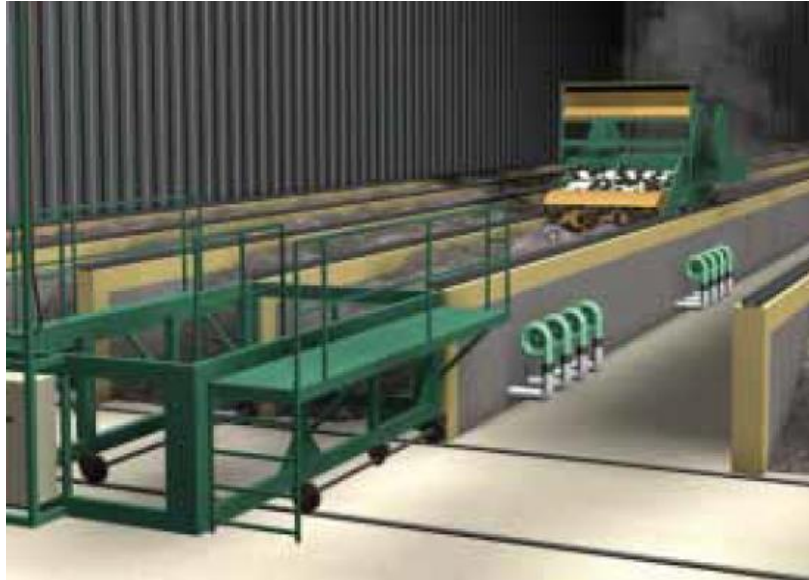
Figura 9: Pila agitada por las paletas de la máquina agitadora en un sistema de camas agitadas.
