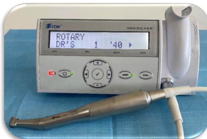
(Fig.5.) Motor VDW, Silver (Alemania) velocidad de 500 rpm y con un torque de 2,5 N.
