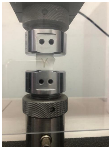
Fig. 2: Cubo siendo sometido a ensayo en máquina INSTRON
