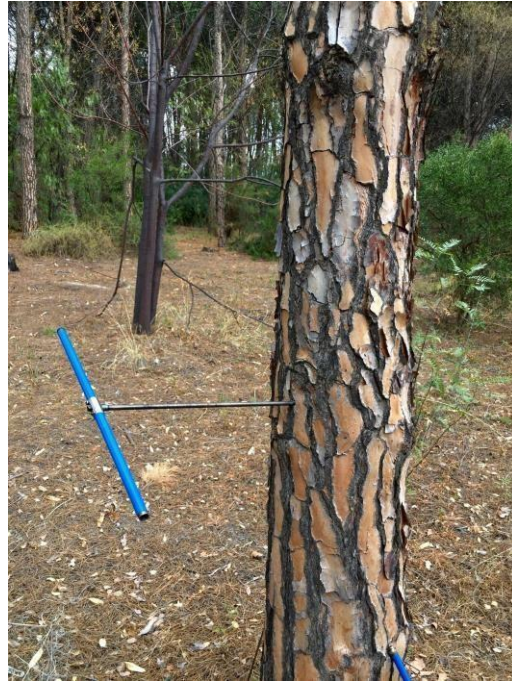
Figura 6. Extracción de tarugo con barreno Pressler Foto: Luciano Diaz Dentoni
