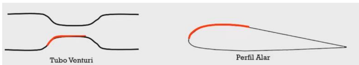
Fig. 4.10 Similitud Tubo Venturi y Perfil Aerodinámico. [30]
