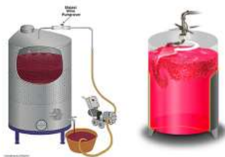
Ilustración 5.13: Representación gráfica de la operación de un Remontaje Abierto.
