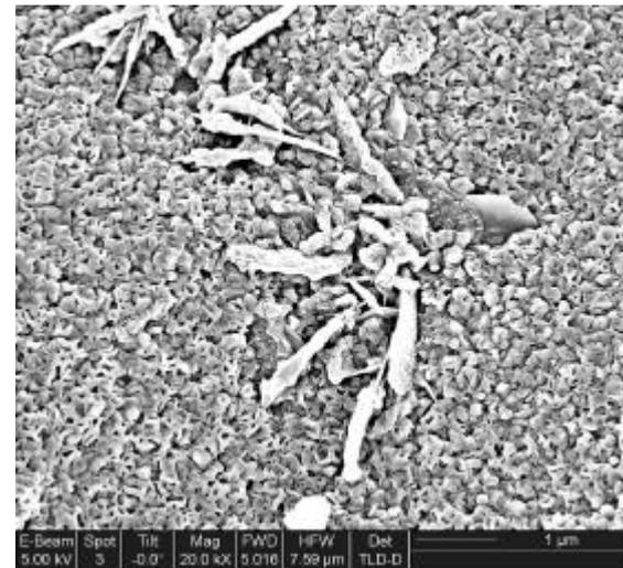
Figs.6(izq.) y 7(dcha.) – (FIB-SEM) de fractura de AR5,585,4h,O2 + 0.5°C/min hasta 650°C.
