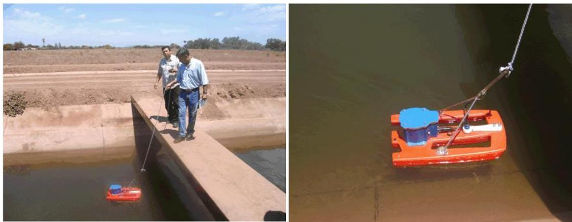
Figura 17 ADCP Integrando velocidad y área      Figura 18 Detalle de ADCP
