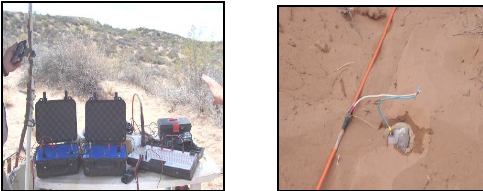
Figura 45. Equipo y electrodos de medición geofísica mediante el Dispositivo Wenner-Schlumberger
