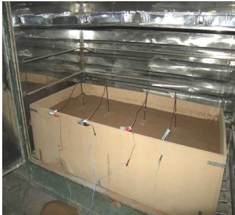
Figura 46. Cuba de arena en estufa y distribución de electrodos para los ensayos de Resistividad-Gradiente de Humedad en laboratorio
