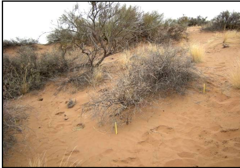
Figura 28. Nebkha en barlovento con estacas graduadas ubicadas en orientación norte, este, oeste y sur
