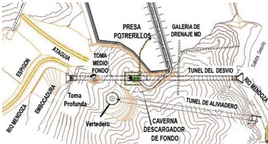
Fig. 11.04.- Planta general de las derivaciones del embalse Potrerillos (de Barchiesi A. y Toso J.M, 2008)
