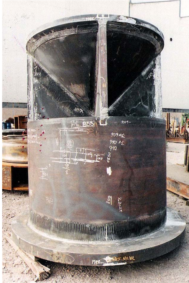
Fot. nº 10.05 Desagüe de fondo Presa Potrerillos. Parte fija de la válvula Howell-Bunger de la derivación de agua para riego.
