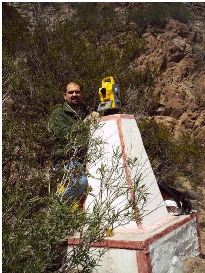
Fot. nº 14.04.- Presa Potrerillos. Estación fija para control geodésico.
