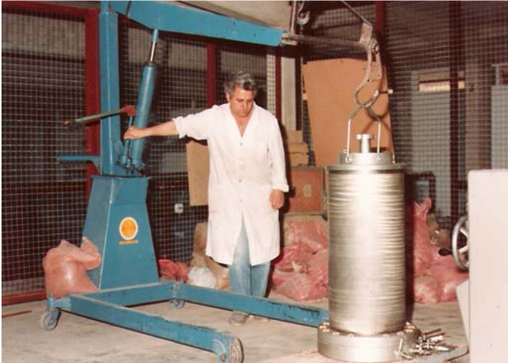
Fot. n° 4.03.- Manipulación de la celda para ensayo triaxial de materiales para una presa en el río Tunuyán (Laboratorio de Ensayos de Suelos de la UNC).
