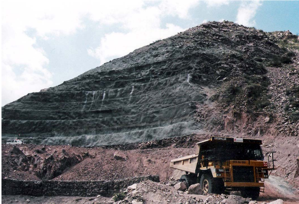
Fot. n° 13.01.- Transporte pesado de materiales en caminos sin pavimento mantenidos para no levantar polvo.
