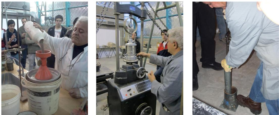
**Figura 3: Ensayos realizados en laboratorio. IZQ: Densidad, CEN: Triaxial, DER: Compactación Proctor**
