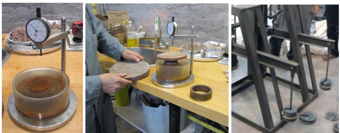
Figura 5: Montaje del ensayo de consolidación unidimensional en laboratorio. IZQ y CEN: Probeta, DER: Pesas para aplicar carga.
