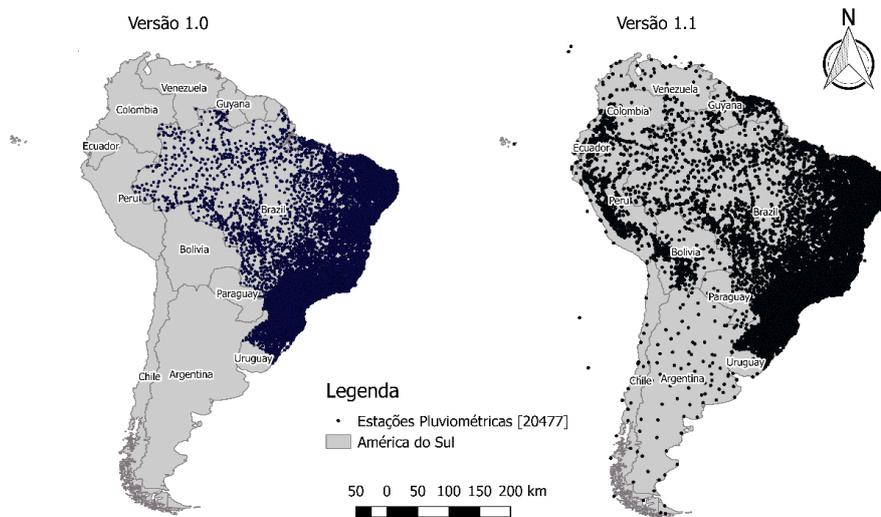
Figura 2. Atualização feita no *plugin* ECO-Pluvia Downloader para aumentar a abrangência de estações pluviométricas.
